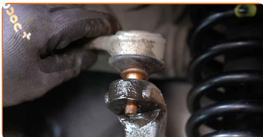
**44** Înșurubați elementul de fixare care unește brațul suspensiei de fuzetă. Utilizați o cheie tubulară №17. Folosiți o cheie cu clichet.
