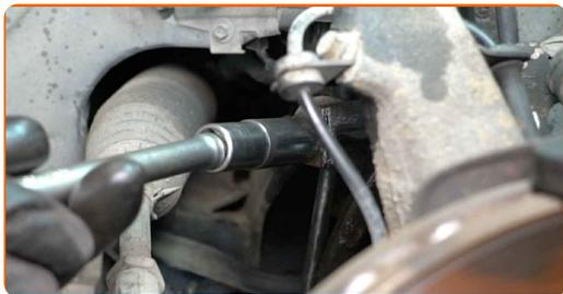
**48** Conectați cablajul senzorului ABS.
