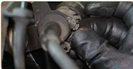
**51** Strângeți șurubul de fixare ce unește ansamblul amortizor cu furca amortizorului. Utilizați o cheie tubulară №18. Folosiți o cheie de cuplu. Strângeți pînă la cuplul de 85 Nm.
