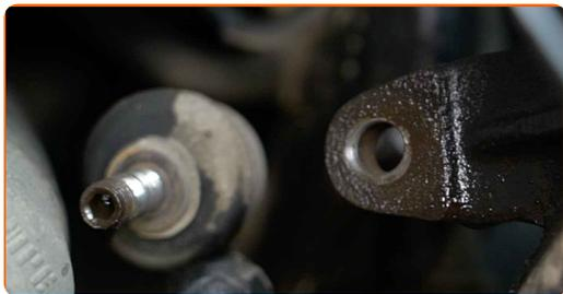
**15** Curățați șurubul de fixare ce unește furca amortizorului cu brațul de suspensie inferior. Folosiți o perie de sârmă. Folosiți spray WD-40.
