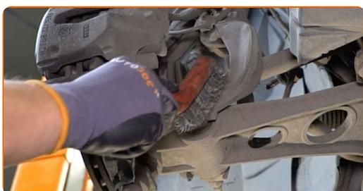
**16** Deșurubați șurubul de fixare ce unește furca amortizorului cu brațul de suspensie inferior. Utilizați o cheie în combinație fixă №19. Utilizați o cheie tubulară №19. Folosiți o cheie cu clichet.
