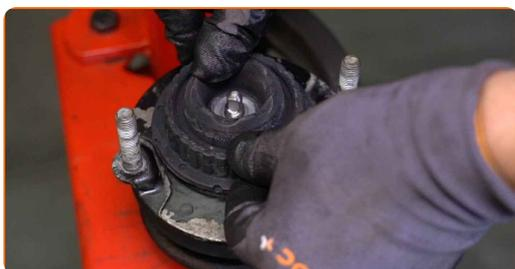
**33** Strângeți șurubul tijeii pistonului barei de sprijin amortizor. Folosiți o cheie de amortizoare DDN#6 Utilizați o cheie tubulară N#16. Folosiți o cheie de cuplu. Strângeți până la cuplul de 35 Nm.
