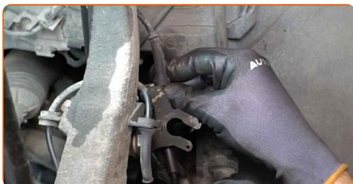
**49** Fixați pe suport furtunul sistemului de frânare.
