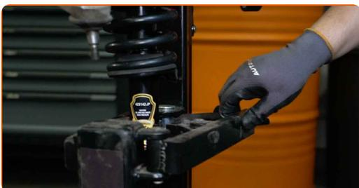
**37** Curățați locurile de montare ale telescopului amortizorului. Folosiți o perie de sârmă. Folosiți spray WD-40.
