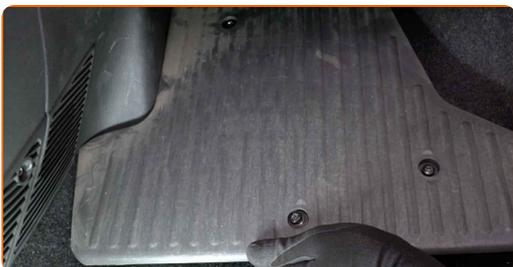
13 Înșurubați dispozitivul de fixare al rezemătorii de picior. Folosiți o șurubelniță Phillips. Folosiți o cheie cu clichet.
