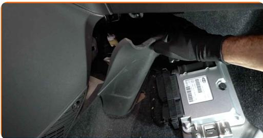
**5** Deșurubați elementele de fixare ale capacului carcasei filtrului de habitacul. Folosiți o șurubelniță Phillips. Folosiți o cheie cu clichet.
