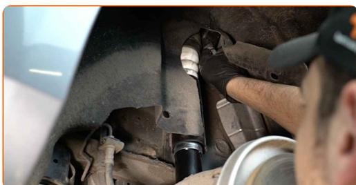
**27** Înșurubați elementul de fixare de sus al amortizorului. Utilizați o cheie tubulară №16. Folosiți o cheie cu clichet.
