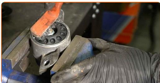
**18** Îndepărtați elementul de fixare al tijei pistonului amortizorului. Folosiți o cheie de amortizoare DDN<sup>®</sup>6. Utilizați o cheie tubulară N<sup>o</sup>16. Folosiți o cheie cu clichet.
