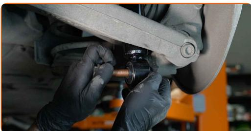
**29** Înșurubați elementul de fixare de jos al amortizorului. Utilizați o cheie tubulară №21. Folosiți o cheie cu clichet.
