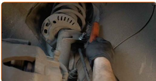
**14** Deșurubați elementul de fixare ce unește bieleta antiruliu de telescopul amortizorului. Utilizați o cheie tubulară №18. Folosiți o cheie cu clichet.
