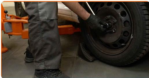
**9** Slăbiți șuruburile de fixare a roții. Folosiți o cheie tubulară de impact pentru roată #17.
