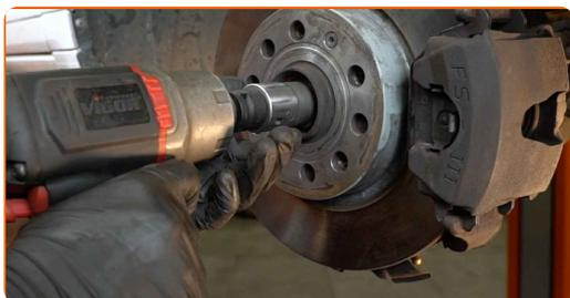
**59** Înșurubați elementele de fixare ce unesc ansamblu amortizor la portfuzetă. Utilizați o cheie tubulară №18. Folosiți un bit XZN nr.14. Folosiți o cheie cu clichet.
