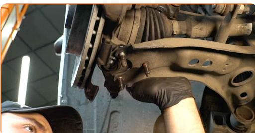
**57** Înșurubați elementele de fixare ale articulației sferice. Utilizați o cheie tubulară №16. Folosiți o cheie cu clichet.
