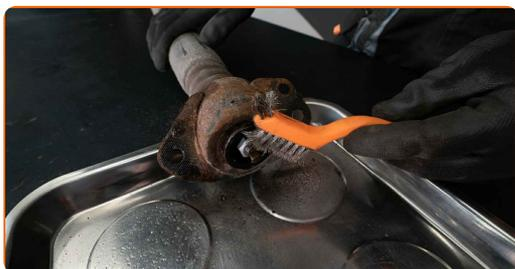
**14** Îndepărtați elementul de fixare al tijei pistonului amortizorului. Utilizați o cheie în combinație fixă №16. Folosiți o cheie reglabilă.
