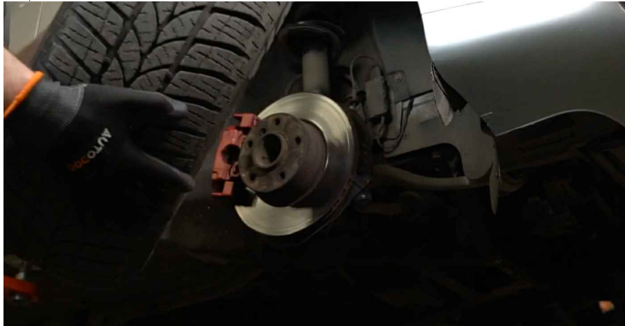
6 Curățați elementele de fixare ale bielei antrului. Folosiți o perie de sârmă. Folosiți spray WD-40.
