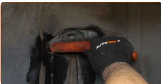
**22** Amplasați amortizorul sub aripa roții și fixați-l.
