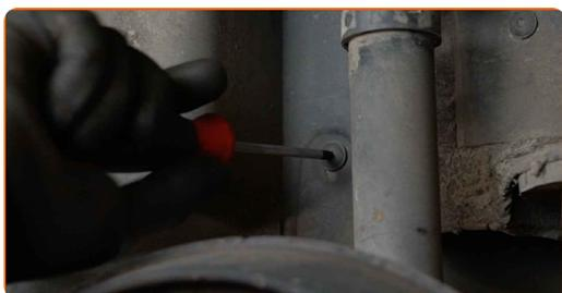
**7** Curățați elementele de fixare ale amortizorului. Folosiți o perie de sârmă. Folosiți spray WD-40.
