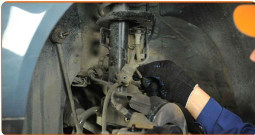
**12** Curătați elementele de fixare care unesc telescopul amortizorului de portfuzetă. Folosiți o perie de sărmă. Folosiți spray WD-40.
