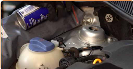
**4** Slăbiți elementul de fixare superior al suportului telescopului amortizor. Utilizați o cheie tubulară №13. Folosiți o cheie cu clichet.
