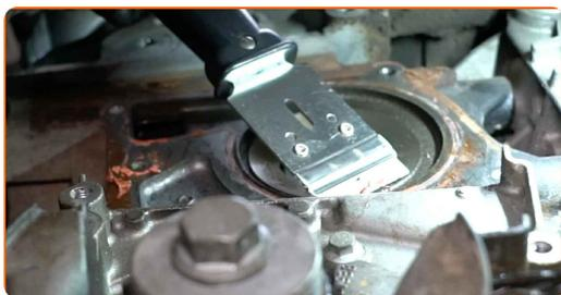
**60** Prelucrați șuruburile de fixare. Utilizați un agent de etanșare.
