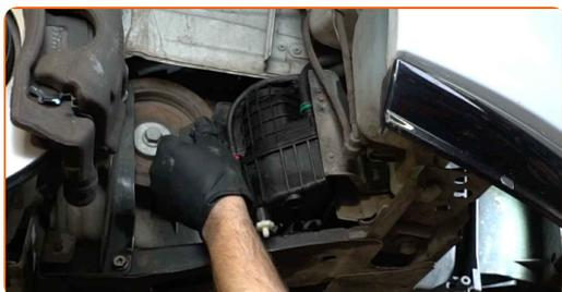
**16** Scoateți deoparte rola de tensionare a curelei de transmisie Poli-V. Utilizați o cheie în combinație fixă №16.
