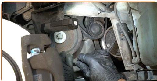
**18** Aduceți rola de tensionare în poziția sa inițială. Utilizați o cheie în combinație fixă №16.
