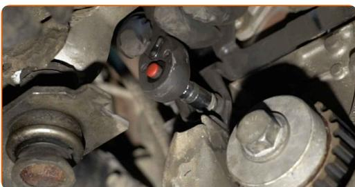
**48** Deșurubați elementul de fixare al rolei de întindere a curelei Poly-V. Utilizați o cheie în combinație fixă №13.
