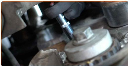
**58** Demontați pompa de apă.
