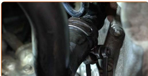
**57** Deșurubați elementele de fixare ale pompei de apă. Utilizați o cheie tubulară №8. Folosiți o cheie cu clichet.
