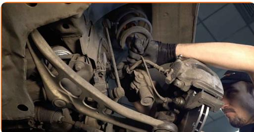
**13** Curățați elementele de fixare care unesc telescopul amortizorului de portfuzetă. Curățați elementul de fixare ce conectează articulația sferică la portfuzetă. Folosiți o perie de sârmă. Folosiți spray WD-40.
