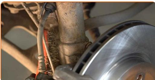
**14** Deșurubați elementul de fixare inferior care unește telescopul amortizorului de portfuzetă. Utilizați o cheie tubulară №18. Folosiți un port tarod.
