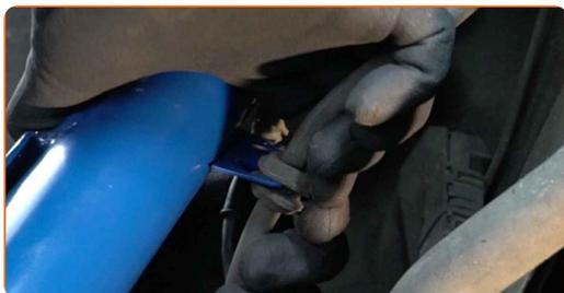
**41** Conectați cablajul senzorului ABS.
