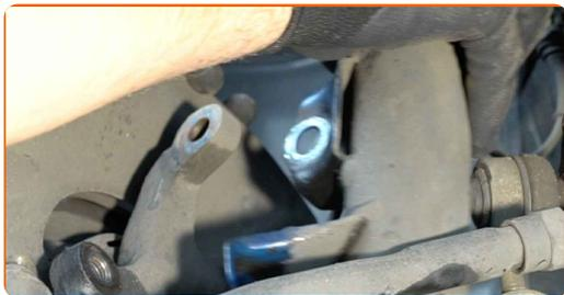
**17** Deșurubați elementele de fixare de sus ale telescopului amortizorului.
