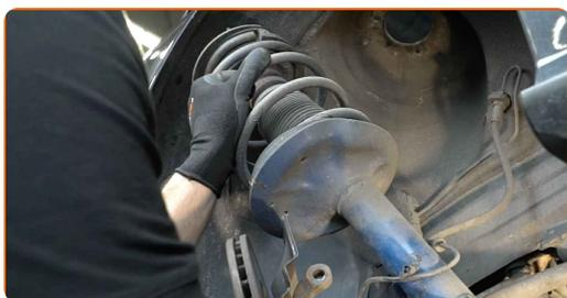
**19** Montați bara de sprijin amortizor pe dispozitivul special pentru comprimarea arcurilor.
