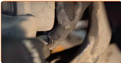
**8** Deconectați fișa senzorului de uzură a plăcuțelor de frână.
